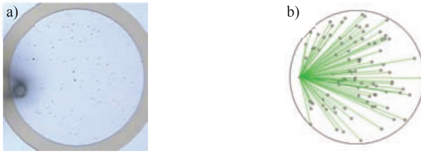
Fig. 4.23. a) Distribución de eventos de ruptura múltiples en una capacidad de área circular de radio r=113\mu\text{m} (caso A.1). La sombra que se aprecia en el lado izquierdo es la punta de medida. b) Localización de los eventos en el área de la capacidad. Las líneas verdes indican la distancia desde la punta de medida hasta cada uno de los eventos.
