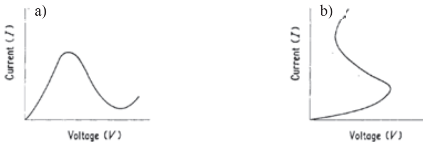
Fig. 2.6. Característica I-V de los dos tipos de NDR: a) tipo N; b) tipo S [86].
