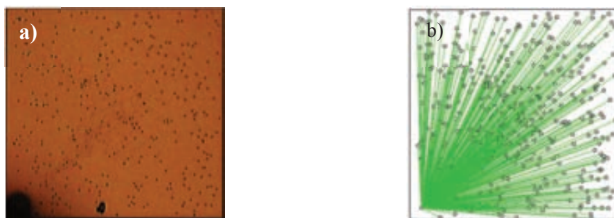
Fig. 4.35. a) Distribución de eventos de ruptura múltiples en una capacidad de área cuadrada con costado a=400\mu\text{m} (caso B.2). La silueta negra que se aprecia en el lado inferior-izquierdo es la punta de medida. b) Localización de los eventos en el área de la capacidad. Las líneas verdes indican la distancia desde la punta de medida hasta cada uno de los eventos.
