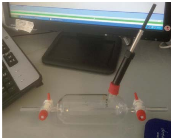
Figura 3.5 Imatge del col·lector de gas amb la fibra SPME al seu interior.
