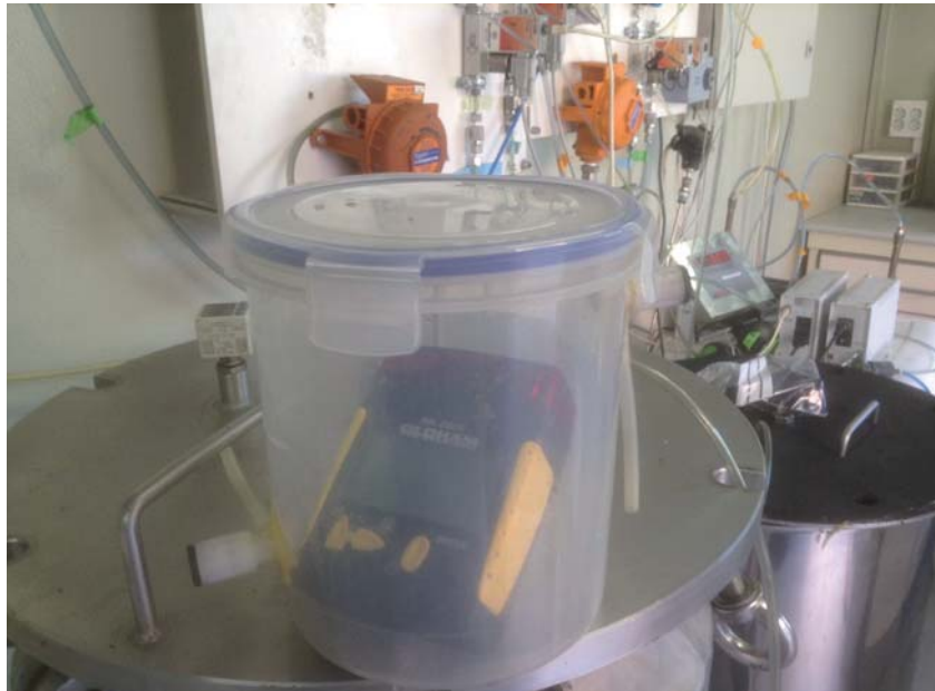
Figura 3.3. Sensor d'amoníac dins el recipient hermètic que permet la mesura de la concentració d'amoníac.
