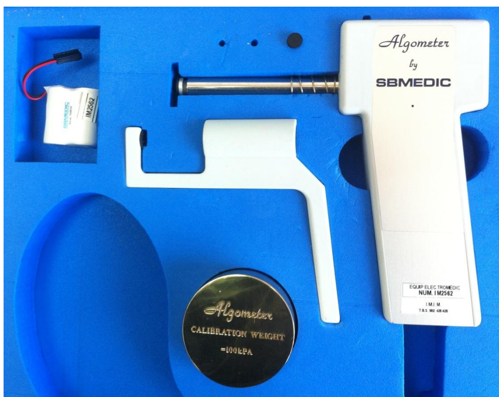
Il·lustració 10. Algòmetre electrònic utilitzat per a l'estudi
