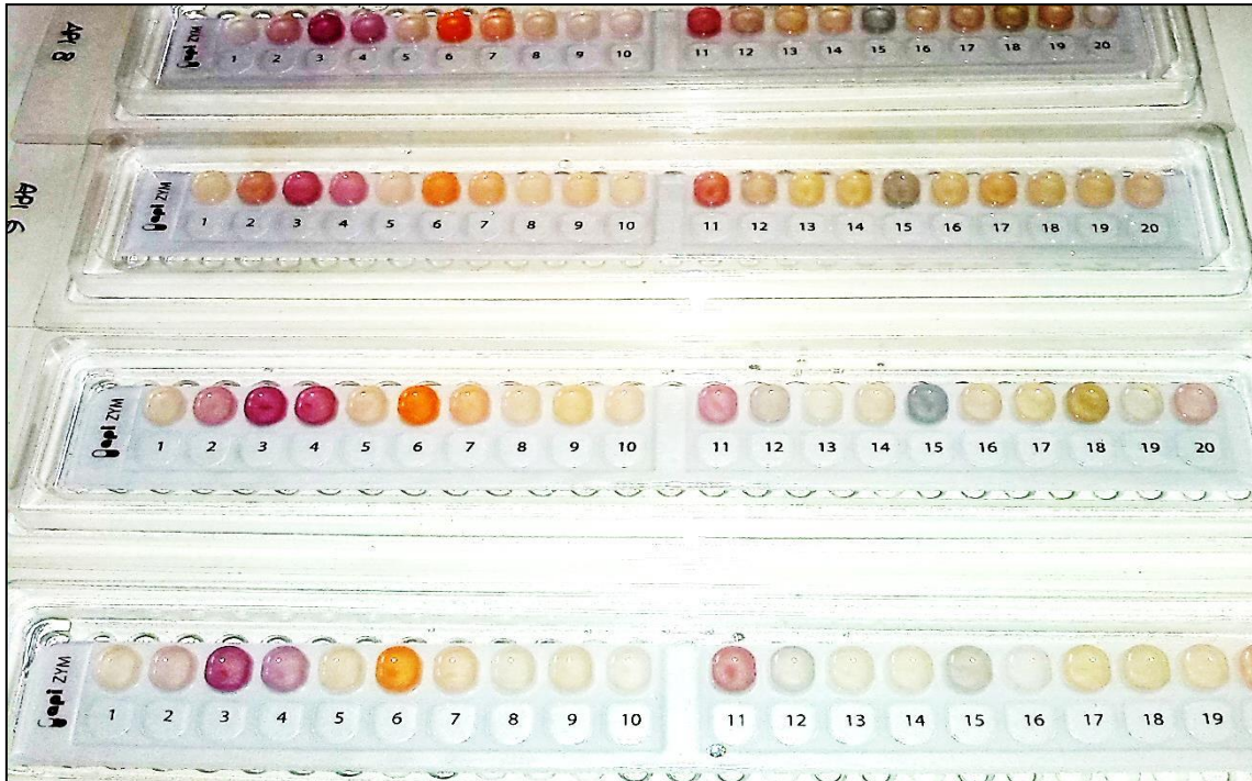
Imatge 20. API ZYM ® inoculat amb llet d'euga, incubat 24 hores i amb els reactius ZymA ® i ZymB ® en el seu interior, a punt per a la seva lectura.
