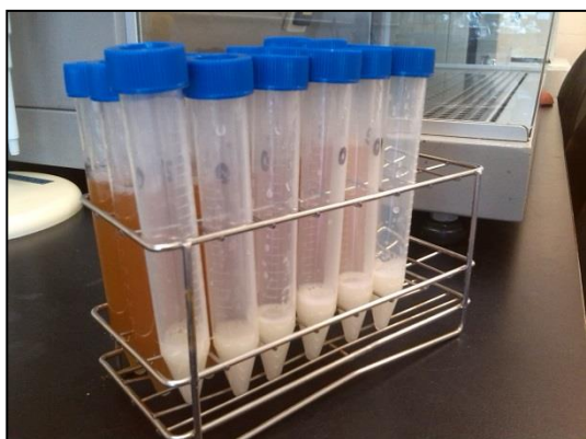
Imatge 25. Tubs de centrífuga amb una de les soques en estudi abans de centrifugar (tubs del fons) i després de centrifugar i suspendre en llet d'euga (primera fila).
