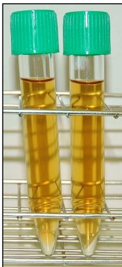
Imatge 24. Pellets separats de la porció líquida per centrifugació
