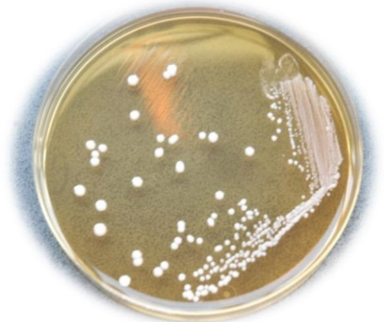
Imatge 10. Placa de medi MRS agar amb una soca làctia sembrada per esgotament.
