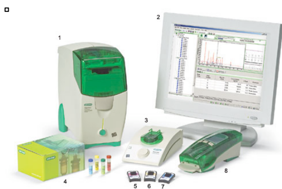
Figura 6.41. Componentes del sistema Experion. Experion es un kit para la electroforesis automática de ácidos nucleicos y en esta tesis se emplea para evaluar la calidad del mRNA extraído de tejidos animales. El kit se compone por:
