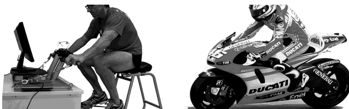
Figura 9. Diseño del simulador. Estructura compuesta por unos manillares y un asiento fijos (izquierda) dotada de unas medidas similares a las de una motocicleta de carreras (derecha).
