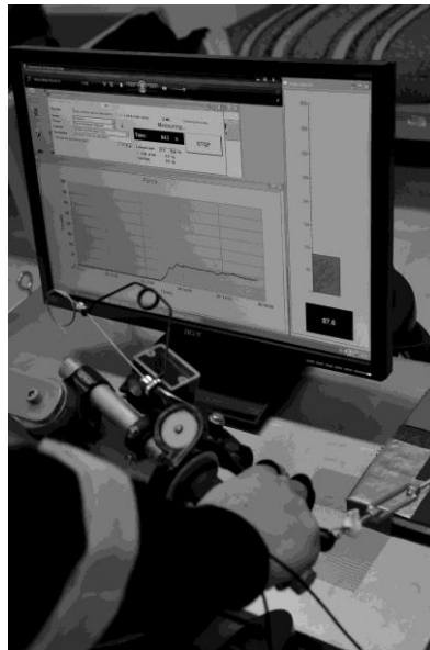
Figura 8. Información visual recibida por el sujeto durante la realización del test. Los sujetos recibían la información en formato numérico, en formato columna y feedback lineal sobre la magnitud del valor de fuerza ejercido.
