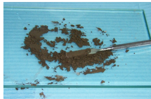
Figura nº 4. Espatulado del cemento.
