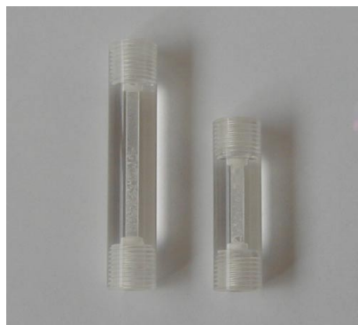
Figura 3. 6: Fotografía de las columnas utilizadas para efectuar la preconcentración del analito.
