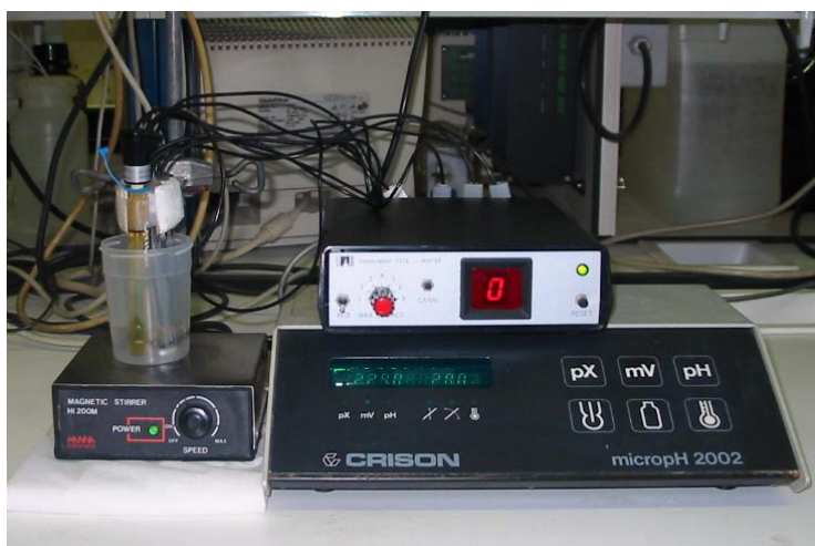
Figura 3.7: Sistema de medida potenciométrico de configuración convencional.
