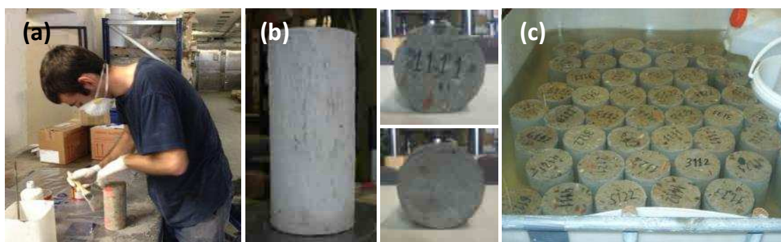
Figura 3.24. a) Aplicación resina epoxy, b) Aspecto testigo, c) Configuración del ensayo
