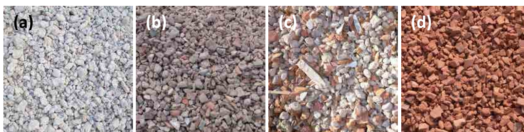
Figura 2.2. Tipo de áridos reciclados. a) ARH, b) ARMh, c) ARMc, d) ARC
