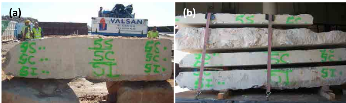
Figura 3.22. a) Marcaje del batache, b) Traslado de las placas hasta el LTE (Batache 5)
