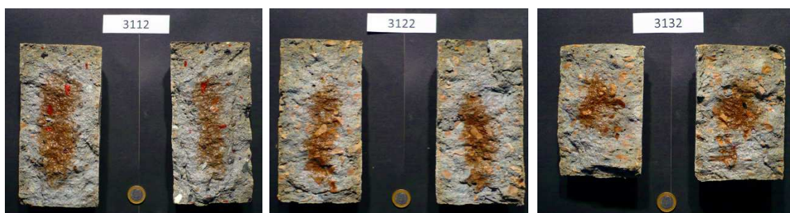
Figura D3.7. a) Dosificación: HRM/AC12; b) y c) Dosificación patrón HM/AC12 - 95 días
