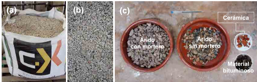
Figura 7.2. Árido reciclado. a) Vista general, b) Detalle, c) Clasificación de componentes
