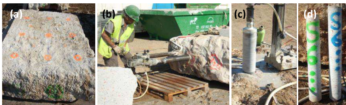
Figura 3.20. a) Cuadrícula TCY, b) Extracción TCZ, c) Extracción TCY, d) Testigos extraídos
