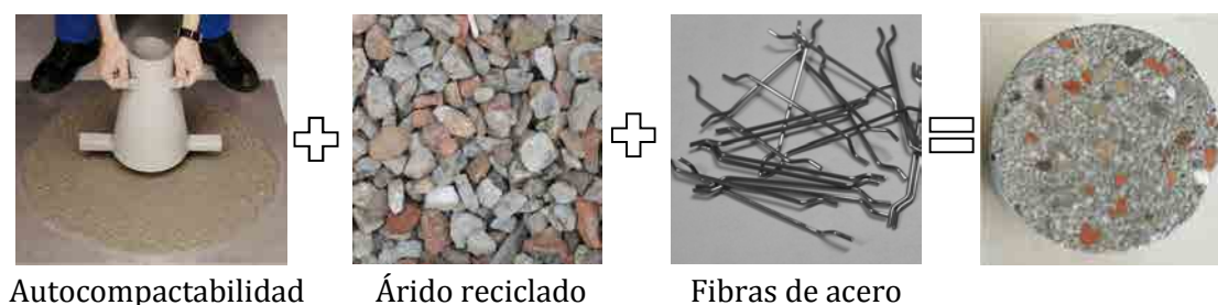
Figura 1.4. Representación del hormigón autocompactante con árido reciclado y fibras
