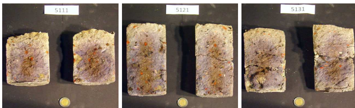
Figura D3.4. Dosificación HRF/AC12-35a - 62 días
