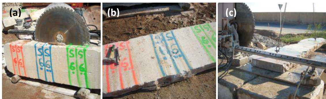
Figura 3.19. Obtención de los testigos prismáticos (TP)
