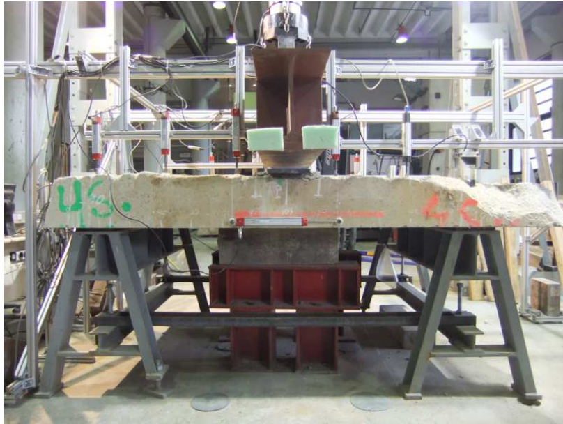
Figura 3.35. Configuración del ensayo. Losa 4S (Luz: 1,90m)
