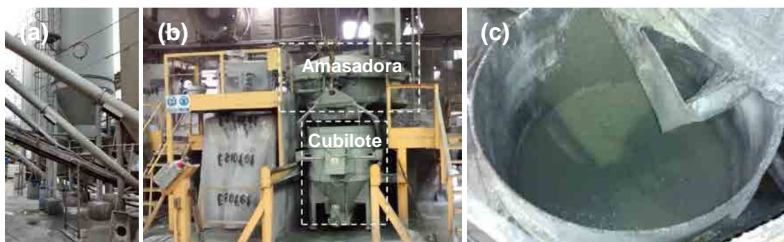
Figura 7.3. a) Silos de áridos, b) Planta dosificadora, c) Aspecto del hormigón tras amasado
