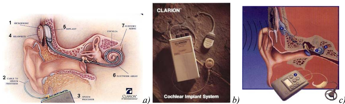
Figura 1.10: Diferents implants coclears comercials a) i b) implants de la casa Clarion® [45] c) implant de la casa Nucleus™ [46]
