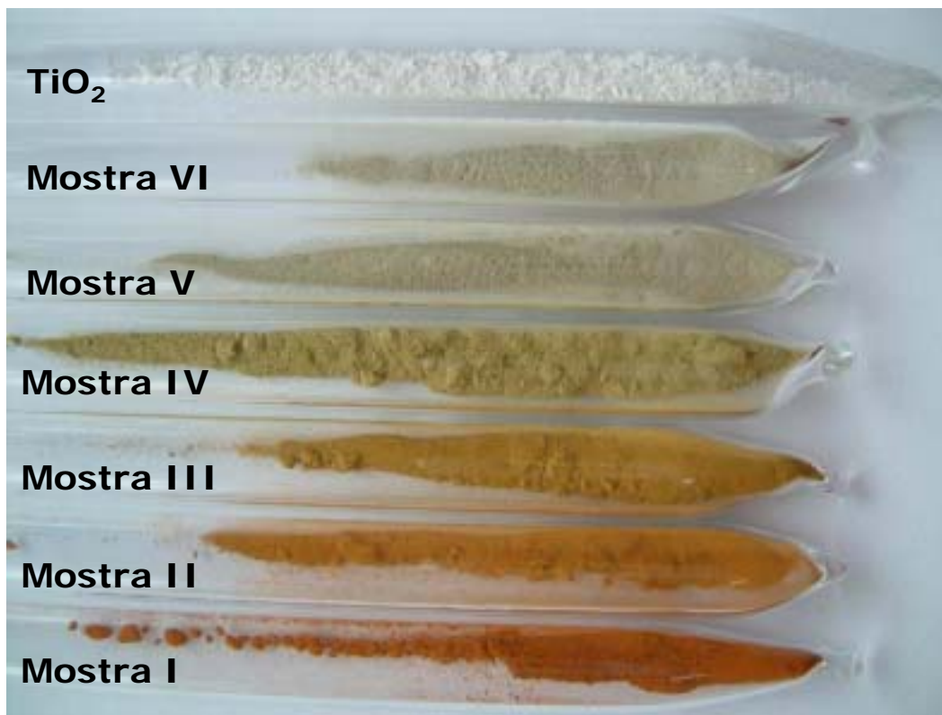
Fig. 3.3: Evolució del color en la sèrie de mostres I a VI, preparades amb un contingut creixent d'oxigen en la barreja de reacció. A efectes comparatius, s'inclou el \text{TiO}_2 .
