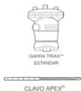
Figura 69. Piezas de anclaje del tubo a la diáfisis.
