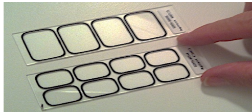
Figura 3.3: Imatge de dos cobreobjectes amb formats (x4) i (x8), caracteritzats per les juntes de silicona dissenyades per a retenir les mostres d'ADN durant la hibridació
