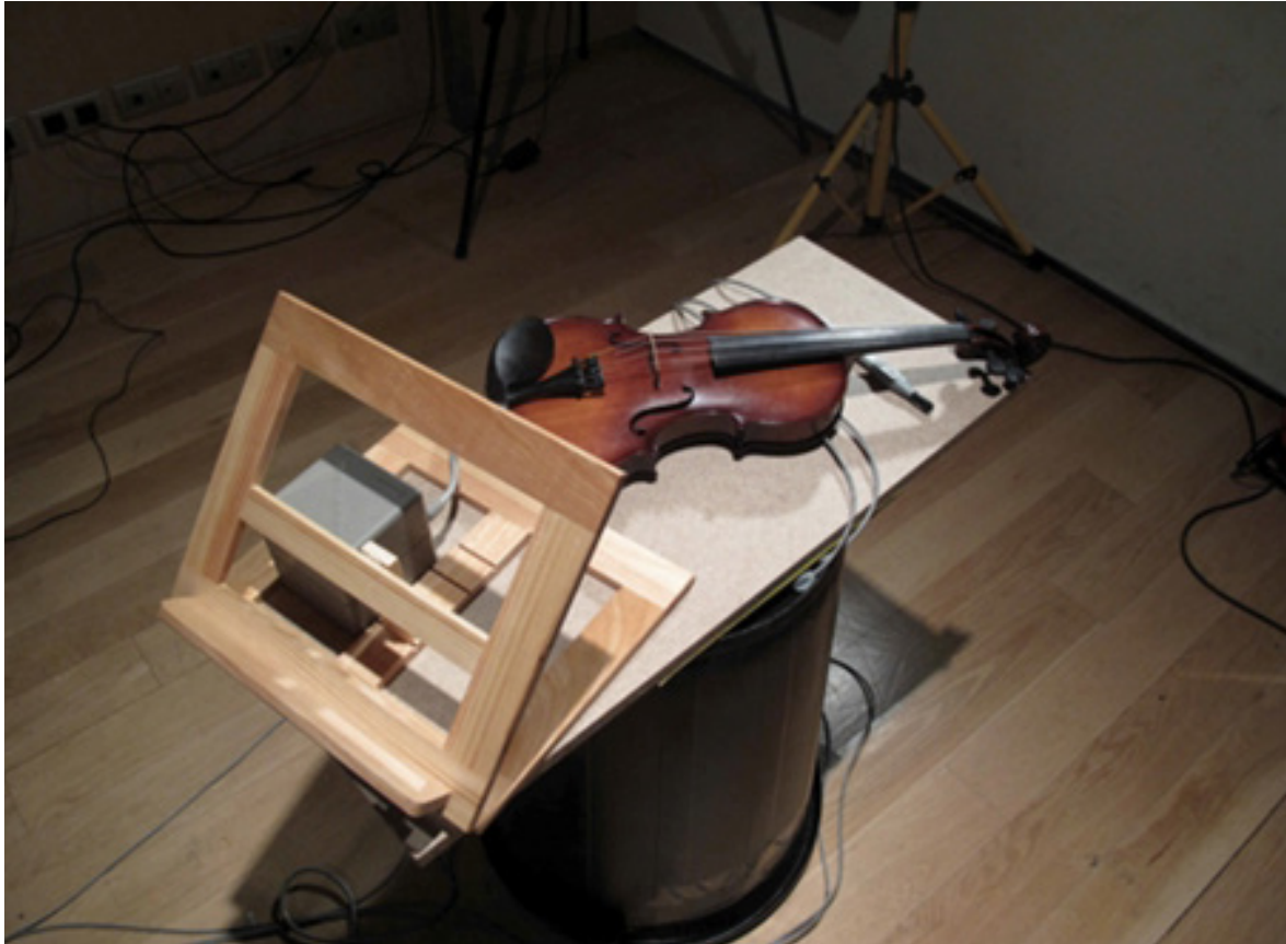
Figura 35. Faristol de fusta per evitar interferències electromagnètiques.
