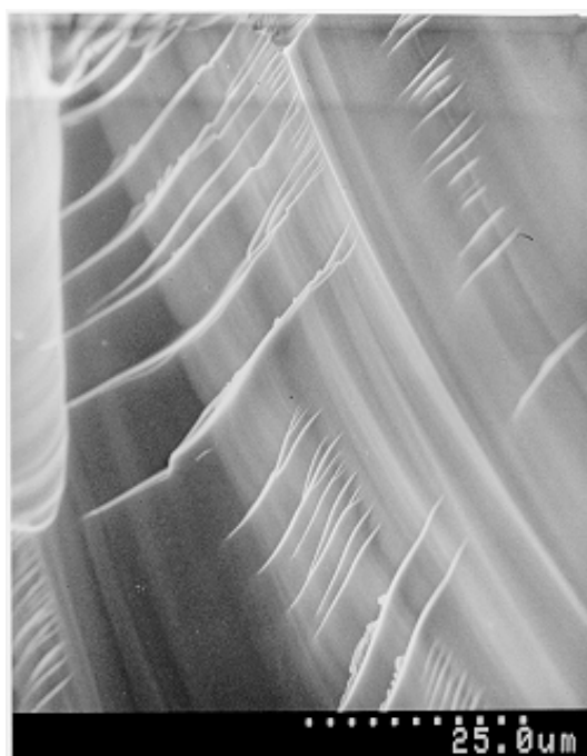
Fig 7.21: Estructuras fibrosas distribuidas encima de las lamelas. (Punto b de la curva de DSC)
