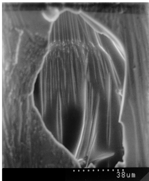
Fig.7.13 Microfotografía mostrando los cristales fibrosos dentro un agujero (punto e de la curva de DSC )
