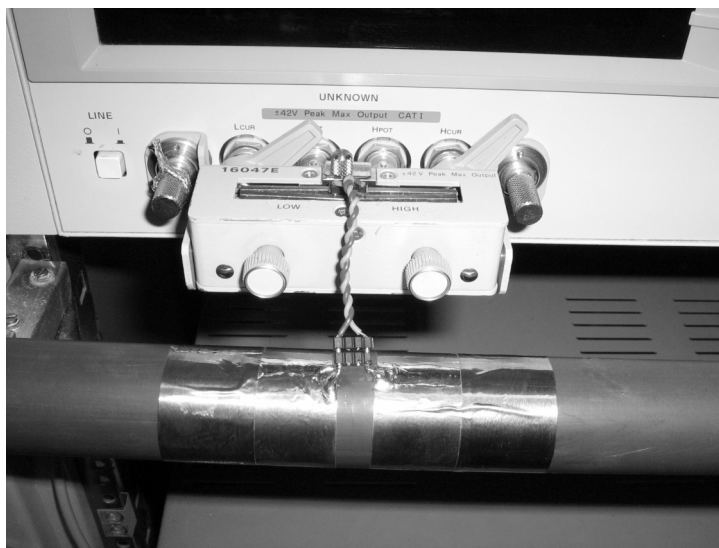
Figura 6.13. Cel·la 3, tub de PVC amb anells de coure enganxats a la part exterior del plàstic.
