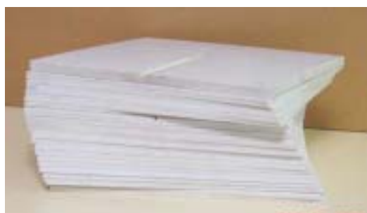
Fig. 2.6 Maniquí de láminas de poliestireno con la lámina de inserción para una cámara cilíndrica de 0.6cc.
