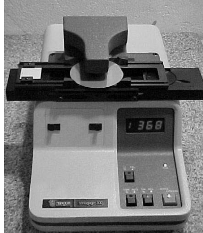
Fig. 43.- Photo de l'équipement SonoGage RT 2 de chez Tencor Instruments utilisé dans ce travail ( http://www.metrologvequipmentservices.com/forsale/sg300.htm ).
