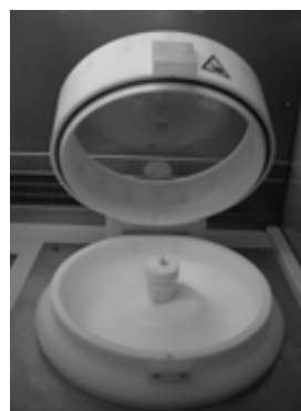
Figura 8.5.- (Izquierda) Esquemas donde se muestran los parámetros de centrifugado para las resinas PMMA A7 y PMMA A2 usadas en este trabajo. (Derecha) Fotografía del centrifugador (o spinner) usado para el depósito de la resina sobre las muestras.
