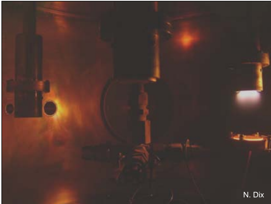
Fig. A.3.- Detalle del proceso de crecimiento donde se observa el calefactor incandescente (hilo de Cántal o Thermocoax comercial) y el plasma generado en el magnetrón.
