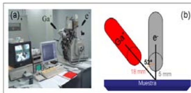
Figura A.22.- (Izquierda) Fotografía del Focused ion Beam de la plataforma de nanotecnología del PCB donde se observa el programa de control del equipo, la fuente de iones de Ga^+ y la de electrones. (Derecha) Esquema de la incidencia de los distintos haces sobre la muestra.
