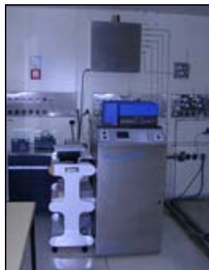
Figura A.24.- Fotografía del equipo de gravado físico (Reactive ion etching) usado en este trabajo.
