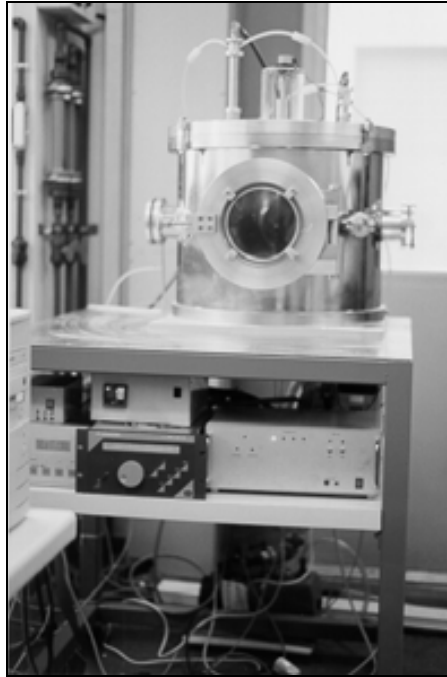
Figura 3.6.- Cámara de RF sputtering utilizada para el crecimiento de las capas finas de LCMO.
