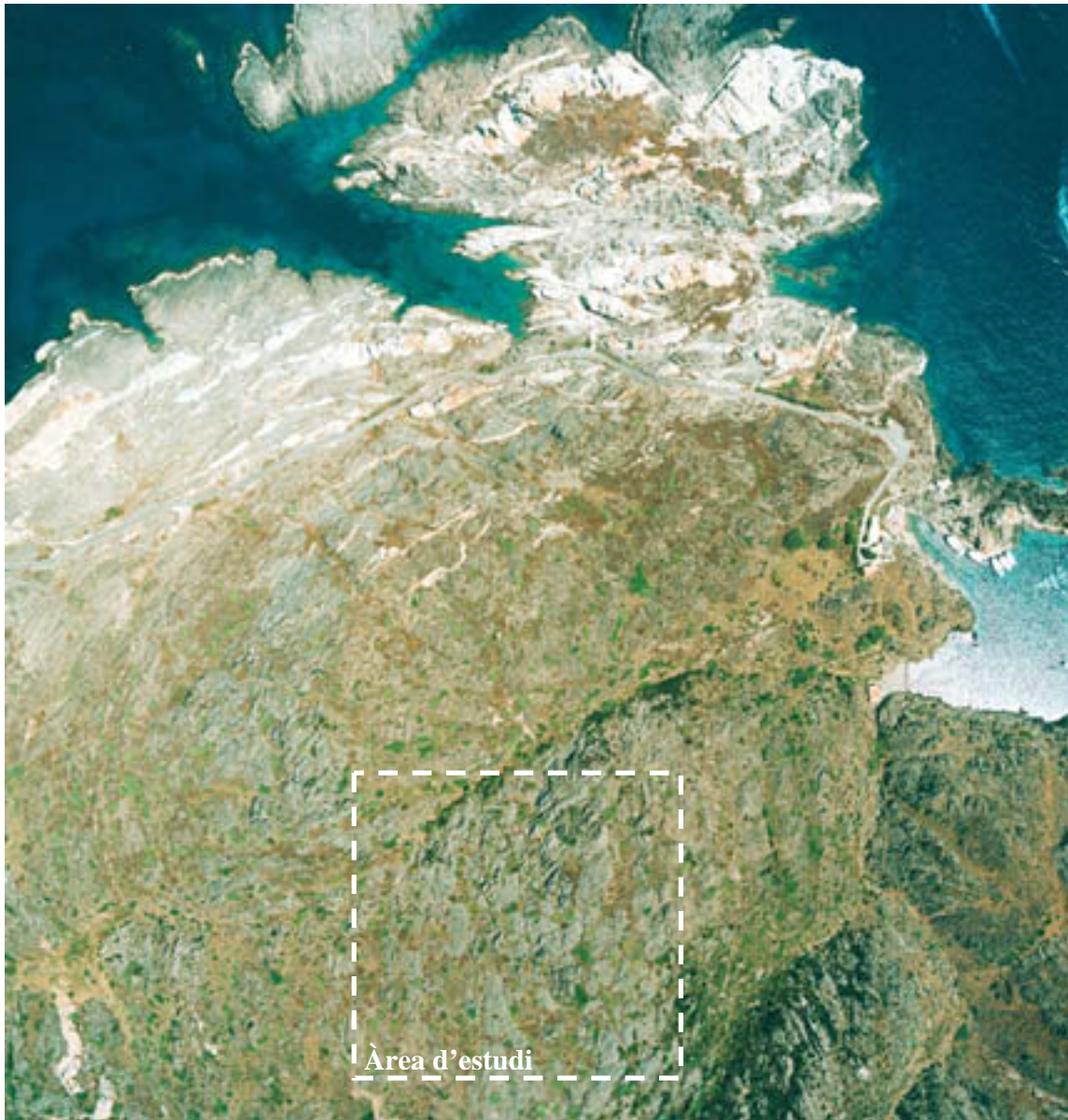
Fig. 3.4 Fotografia aèria de la zona de Puig Culip i Cala Cullaró. La qualitat de l'aflorament permet una cartografia geològica de detall. Els nivells blancs representen cossos pegmatítics emplaçats dins una seqüència metasedimentària d'alt grau metamòrfic. Les bandes discretes que les tallen són zones de cisalla associades a la deformació més tardana (D3). La zona de l'estudi de camp s'ha circumscrit a les zones de menor deformació de la D2 (quadre blanc). El Nord és cap la part superior de la imatge. L'alçada de la fotografia representa ~800 m de longitud. Per localització relativa dins el Cap de Creus veure Fig. 3.2.
