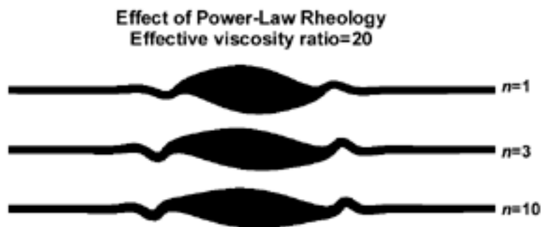
Fig. 5.26 Influència del grau de no linealitat. Desenvolupament de plects a partir d'una configuració de capa aïllada amb una partícula central de Ri=4 . L'augment del grau de no linealitat tendeix a maximitzar l'amplificació de les inestabilitats marginals e inhibir la rotació de la part més massissa. Tots els exemples per condicions de cisalla pura i deformació natural de 0.60.
