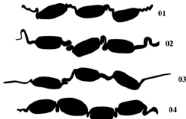
Fig. 6.10 Esquema de la geometria final de la capa de diversos models analògics per observar la repetibilitat de resultats per \alpha=0^\circ . Aquests models presenten una configuració inicial de la geometria pinch-and-swell "perfectament" simètrica. Per aquestes situacions no s'observa una tendència sistemàtica a imbricar-se els boudins, essent la distribució més complexa que la proposat per Penge (1976). Les condicions dels models 02 i 03 són equivalents al model 1 de la taula 6.2, mentre el 04 és el model 10. L'escurçament final paral·lel a la capa és d'un 50% per a tots els models.
