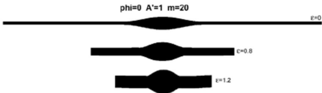
Fig. 4.5. Amplificació d'una pertorbació simètrica aïllada al centre d'una capa planar. L'escurçament paral·lel a la capa és acomodat a partir d'engruiximent d'aquesta. És pot observar l'estabilitat numèrica de l'estructura per taxes de deformació elevades (de més d'un 70% d'escurçament).
