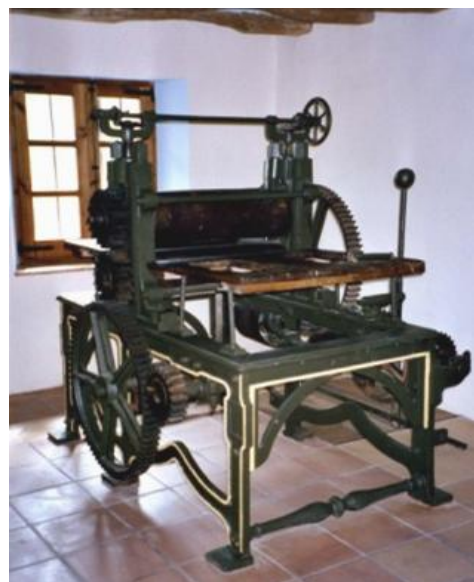
Setinador de corrons fàbrica Munné
