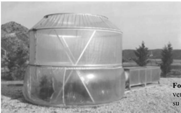
**Fotografía 2.2.** Cámara abierta. El sistema de ventilación y filtración pueden apreciarse en su parte posterior.
