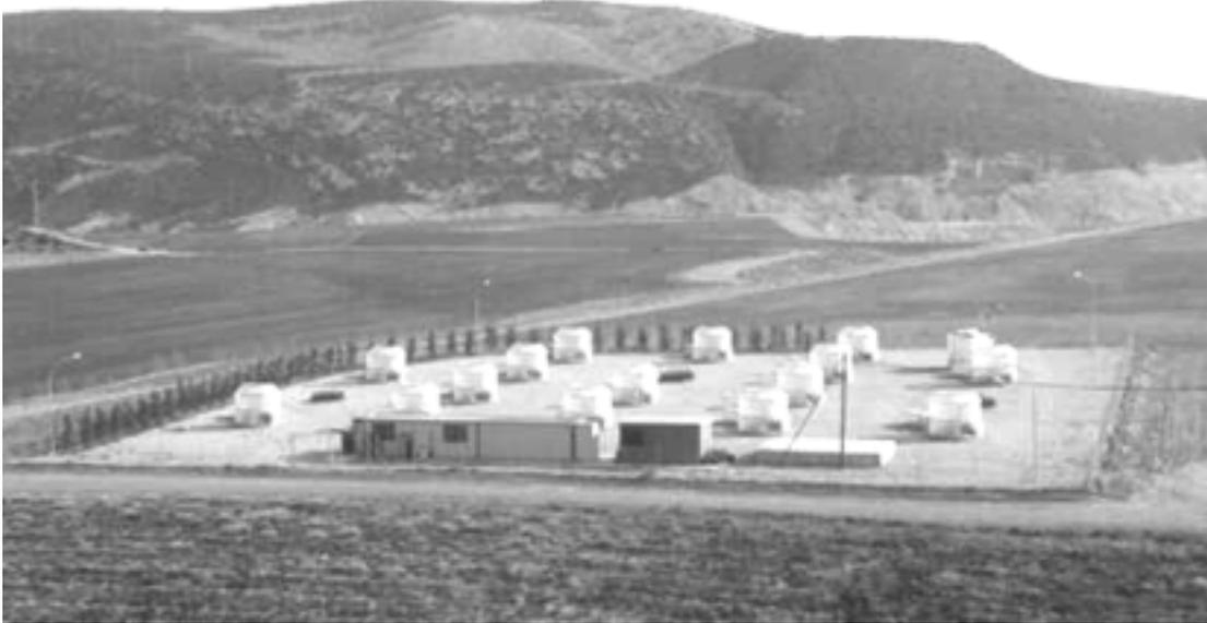
**Fotografía 2.1.** Vista general de la instalación de cámaras OTC. El sistema incluye 15 cámaras abiertas sujetas a diversos tratamientos (AF, AF+SO<sub>2</sub>, AF+O<sub>3</sub>, AF+SO<sub>2</sub>+O<sub>3</sub>, ANF) y tres parcelas de aire ambiente.
