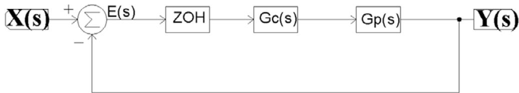
Figura 1-16 Aproximación continua de un sistema de datos muestreados.
