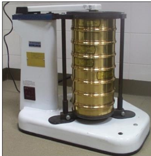
Figura 10. Vibrador mecánico del laboratorio de tamizaje de la escuela de Geología UIS.
