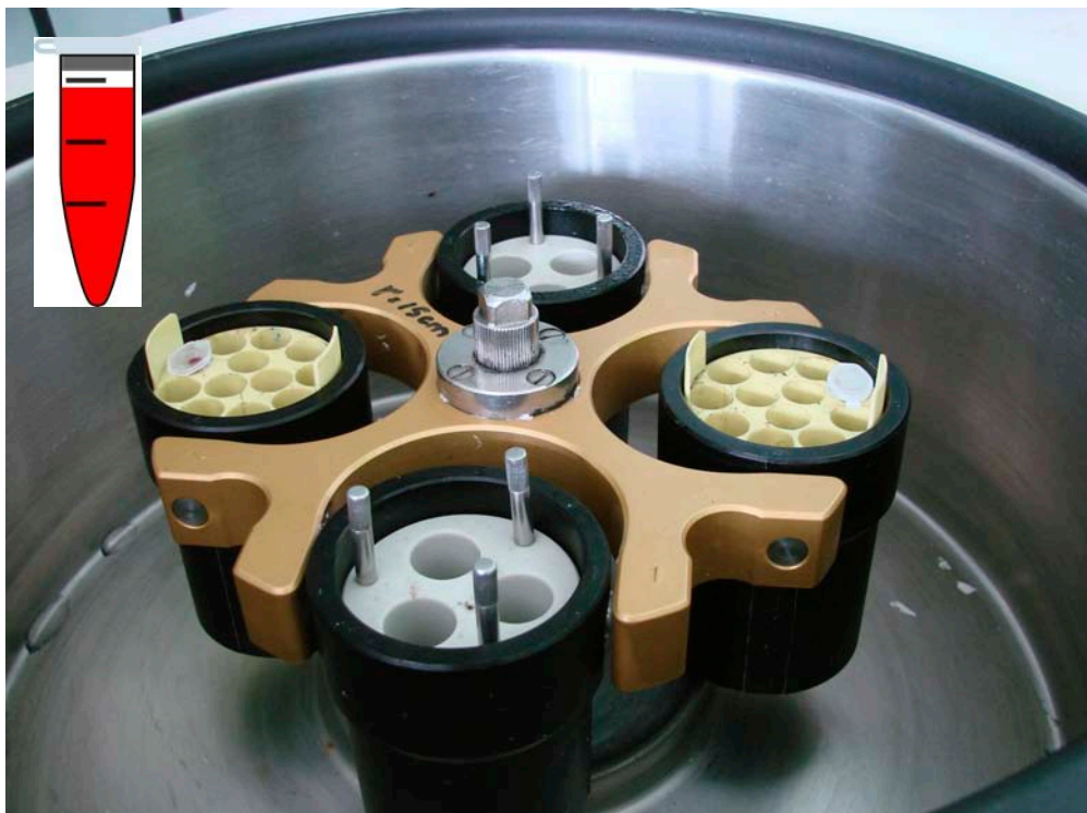
Imagen 36 . Tambor interno de la centrifugadora.
