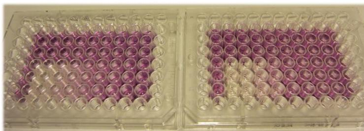
**Figura 18.** Dos placas después de la adición del MTT y disolución de los cristales de formazán. El color rosa indica la viabilidad de las células mientras que la disminución de intensidad indica disminución de la viabilidad. En este caso ambas placas presentaban toxicidad para la CTX.
