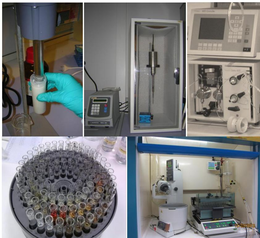
**Figura 17.** De izquierda a derecha y de arriba abajo: proceso de extracción de pescado con ultraturrax, sonda de ultrasonidos empleada para la extracción de microalgas, cromatógrafo utilizado para los fraccionamientos, carro de fracciones y rotavapores utilizados para la evaporación de estas fracciones y extractos.
