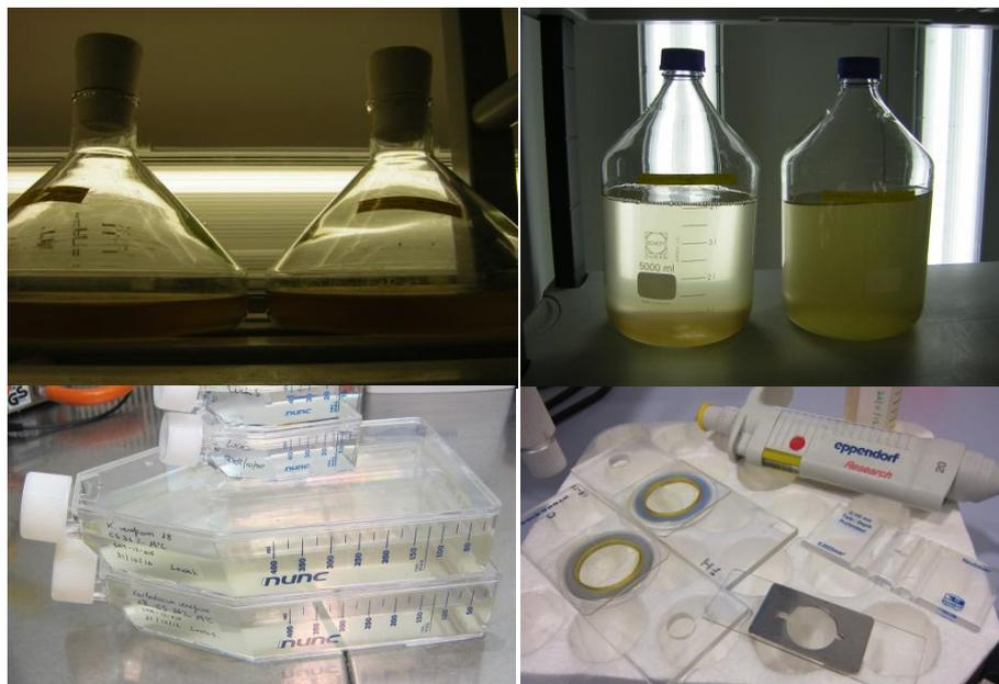
**Figura 16.** De izquierda a derecha y de arriba abajo figuran los fermbatch, botellones 8 L, frascos de cultivo celular y algunas de las cámaras usadas para los recuentos: dos cámaras Utermöhl (centro derecha), una cámara Palmer-Maloney y una cámara Newbauer, esta última utilizada principalmente para los recuentos de los cultivos celulares.
