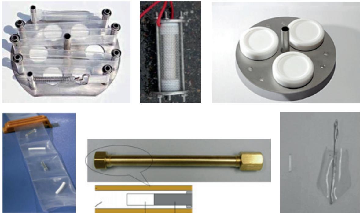
Figura 22. Fotografías de dispositivos de muestreo pasivo para contaminantes hidrofóbicos: (a) SPMD, (b) Dosímetro cerámico, (c) Chemcatcher, (d) MESCO, (e) LDPE SPME-TWA, (f) barra y lámina de SR
