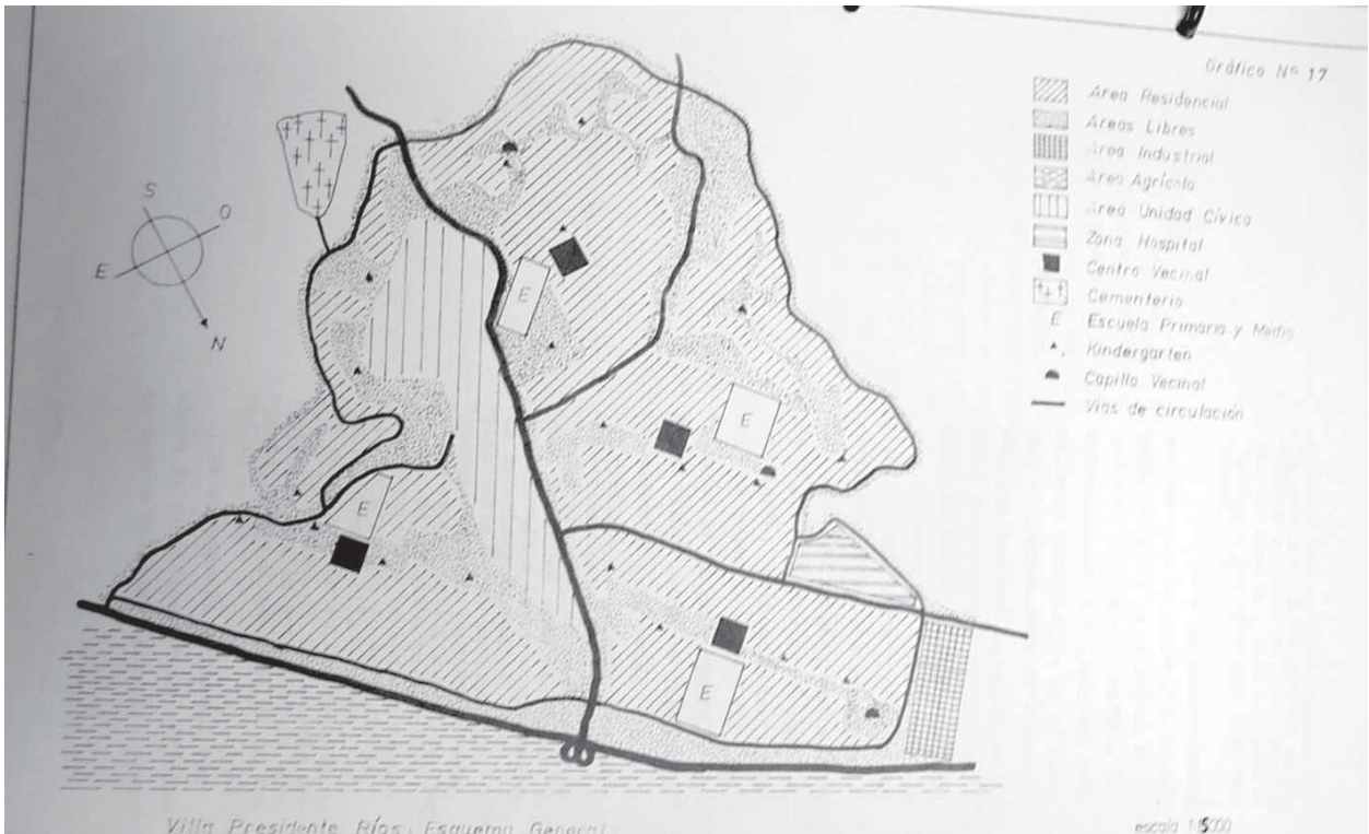
Imagen 3.10: Villa Presidente Ríos, Sergio Larraín, Emilio Duhart, arquitectos, 1949- 1951. Escala 1:15.000. Esquema General, definición de Centros vecinales y Escuelas primarias por cada unidad Vecinal. Fuente: Sánchez, 1960, Op. Cit.
