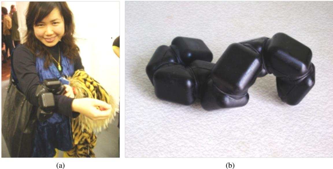
Figura 12.3: *ADB (After Deep Blue)*, robot compuesto de varios módulos y sensores con los que detectar el contacto con el agente. El contacto da lugar a la activación de patrones de movimiento. (a) *ADB* con un agente. En estado de interacción y movimiento. (b) *ADB* sin contacto humano. En estado de quietud, sin movimiento.
