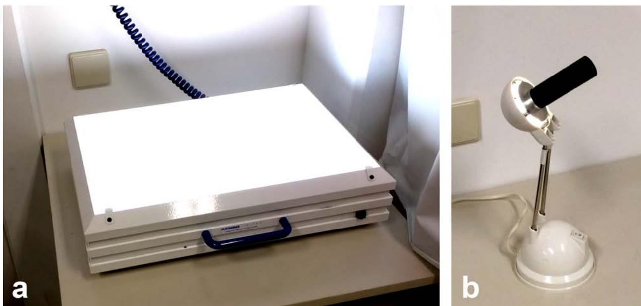
Figura 5.13: (a) Caja de luz; (b) Vitreoscopio
