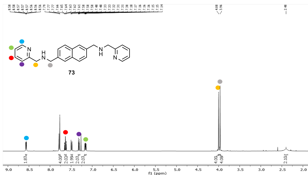
Figura 3.22. Espectre ^1\text{H} -RMN del producte 73 objectiu amb els senyals característics assignats. L'espectre està realitzat amb DMSO com a dissolvent.
