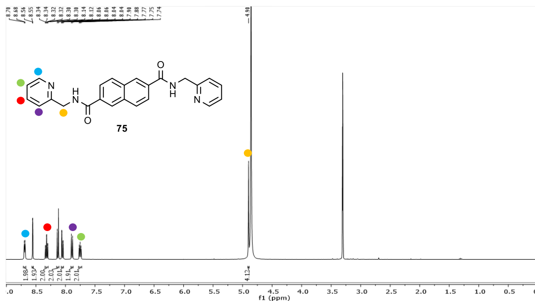
Figura 3.21. Espectre 1 H-RMN de l'intermedi amida 75 amb els senyals característics assignats. L'espectre està realitzat amb DMSO com a dissolvent.
