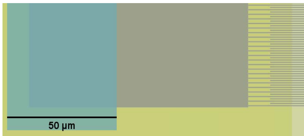
Figura 5-4: Representació gràfica on es veu un detall d'un extrem dels elèctrodes interdigitats i s'observa la superposició de les pistes d'alumini amb la barra col·lectora de silici policristal·lí.
