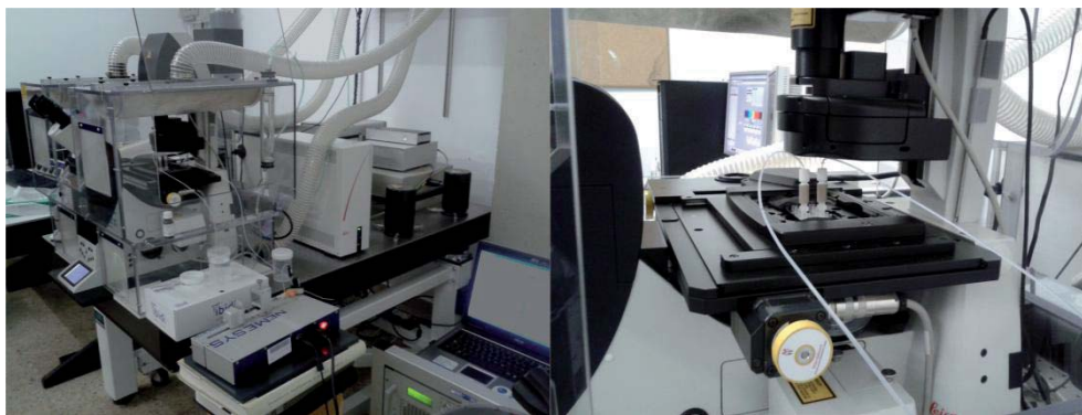
Figura 5-16: Fotografies del muntatge complet per fer l'estudi. Integració del sistema microfluídic dins l'equip de microscòpia confocal. A l'esquerra es veu el microscopi confocal, l'aparell de bombeig amb la xeringa i l'ordinador portàtil que controla el bombeig. A la dreta s'observa més detalladament el posicionament del portaobjectes i les entrades i sortides del canal.
