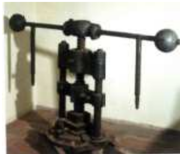
Fig. 2.20 Prensa de Volante manual con bolas. Finales del siglo XIX. Museo del Azulejo de Onda (1)
