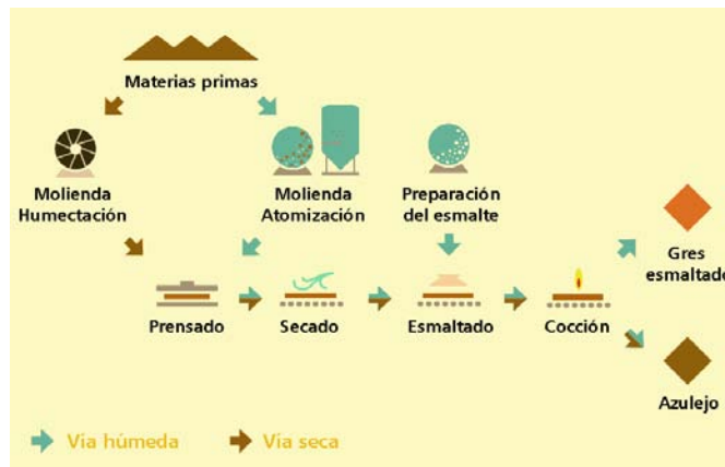
Figura 2.23 Esquema del proceso de fabricación de baldosas cerámicas vidriadas
