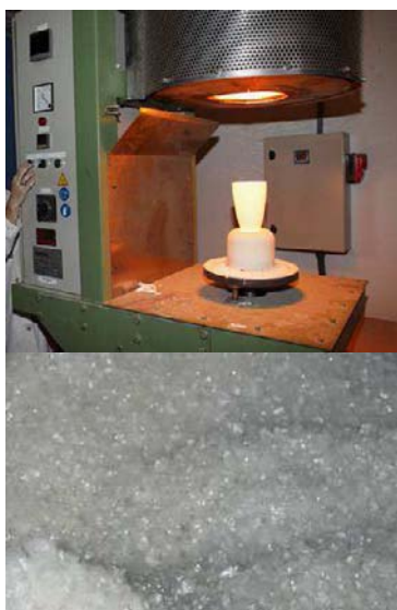
Figura 4.3 Imagen la obtención de fritas y una frita cerámica
