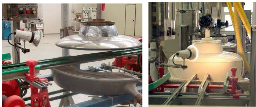
Figura 4.5 Fotografía de la campana utilizada en la realización de las pruebas, previamente y durante el proceso de esmaltado.
