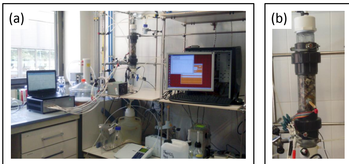
Figura 4.7. (a) Imagen del sistema experimental que conforma el respirómetro heterogéneo. (b) Detalle de la columna del BFP.
