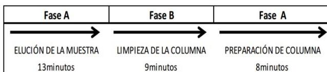
**Figura 18. Programación de la duración (minutos) de las fases A y B durante un cromatograma del análisis de MDA.**
