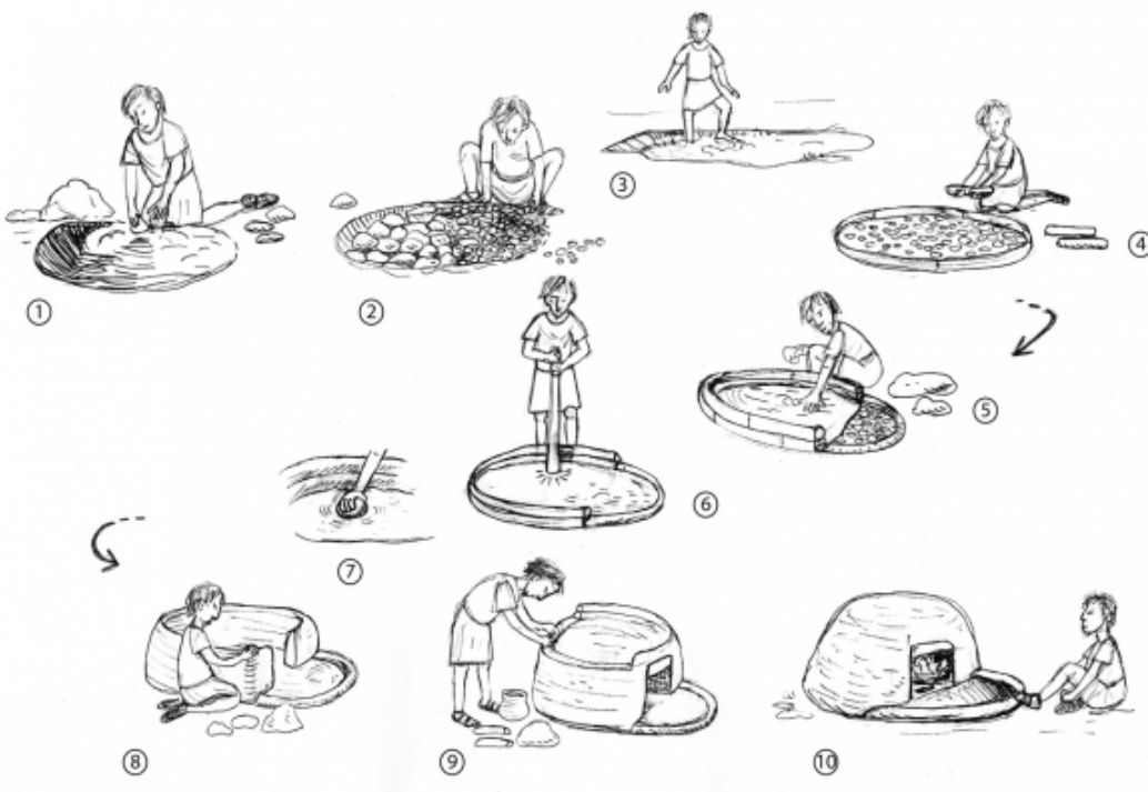
Fig.6.6. (Adaptación figura 10. Esquema de las diferentes etapas de construcción de un horno
