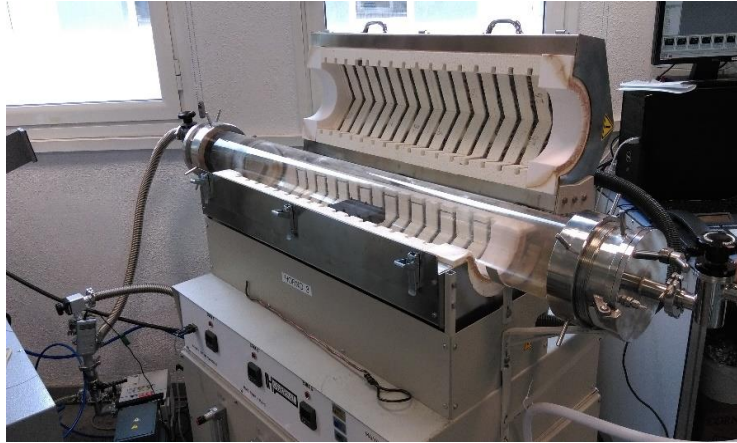
Figura 78. Horno tubular empleado para los tratamientos de kesterita (IREC).
