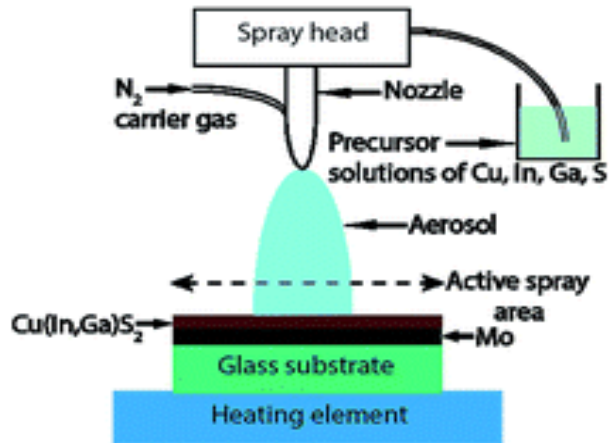
Figura 16. Esquema del proceso spray-pirólisis para obtención de estructura CIGS.
