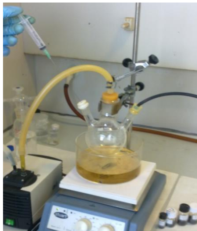
Figura 75. Montaje experimental del procedimiento “hot-injection”.
