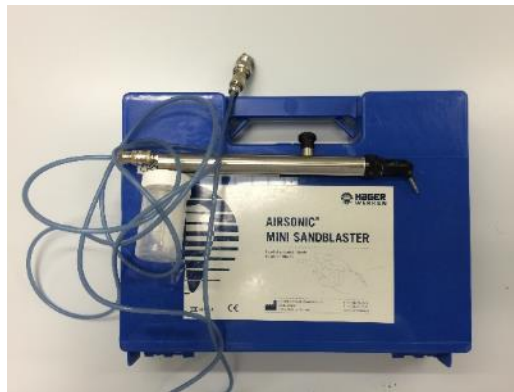
Figura 7-16. Chorreadora Airsonic® Mini Sandblaster.
