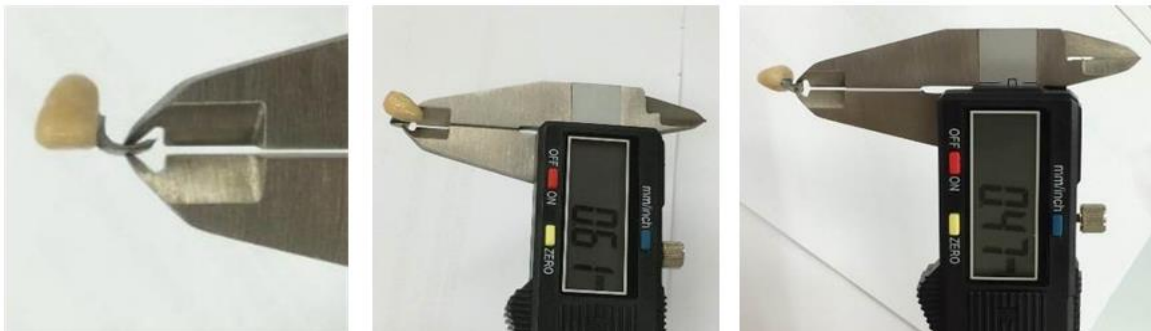
Figura 7-15. Comprobación mediante el pie de rey electrónico de las dimensiones de las prótesis confeccionadas en tres lugares distintos.
