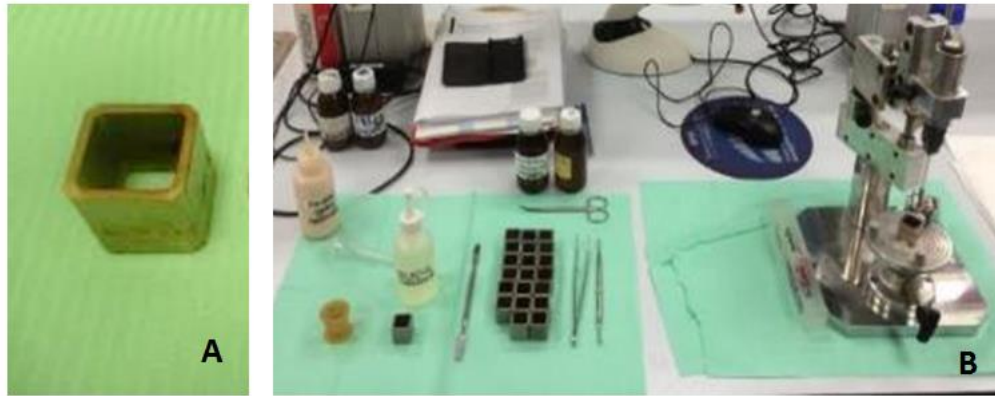
Figura 7-5. A. Tubo de acero utilizado para el encofrado. B. Material y paralelizador utilizado para el encofrado y sembrado.
