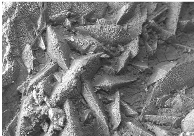
Figura 21. Vista al microscopio electrónico de barrido de cristales de OCD con la típica morfología en punta de lanza. Su superficie muestra signos de inicio de disolución en un proceso de transformación en OCM.
