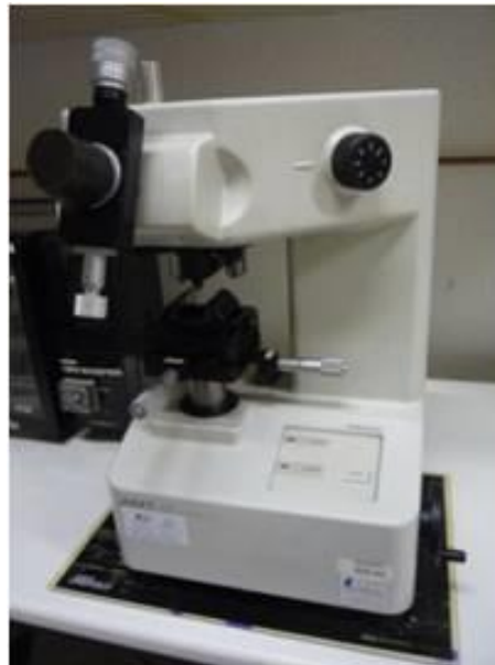
Figura 3.28. Diagrama esquemático de obtención de la indentación para microdureza (arriba) y microdurómetro Matsuzawa MXT
