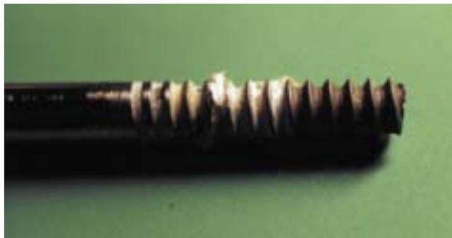
Figura 4.53: clavo recubierto de hidroxiapatita fracturado en el momento de la extracción (caso 20, clavo distal del grupo proximal).
