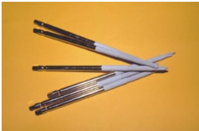
Figura 1.40: Clavos de fijación externa recubiertos de hidroxiapatita por *spray* de plasma.
