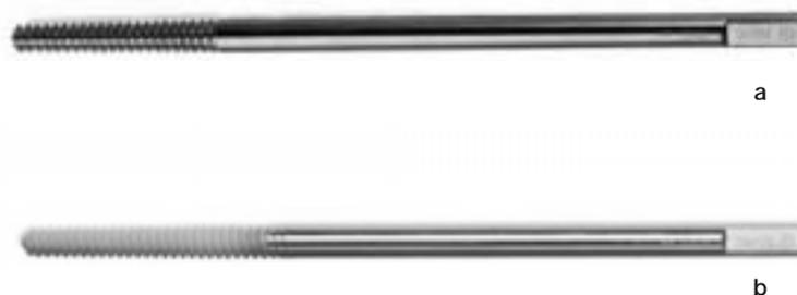
**Figura 3.2:** clavos de fijación externa Orthofix® troncocónicos (fileteado de 6 a 5 mm de diámetro). a) clavo convencional de acero no recubierto. b) clavo recubierto de hidroxiapatita en su parte roscada por la técnica de *spray* de plasma (Osteotite®).
