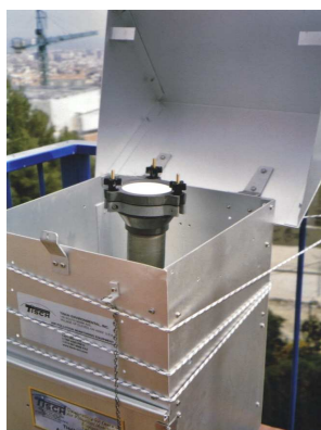
Figura 3.6. Capçal del captador TE-1000, on s'observa el filtre sobre el que queden les partícules.
