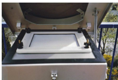
Figura 3.8. Captador de partícules amb l'inlet pujat de manera que queda a la vista el filtre on queden retinudes les partícules ambientals \text{PM}_{10} .
