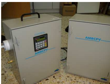
Figura 3.9. Captador de compostos orgànics volàtils AMBCPV.
