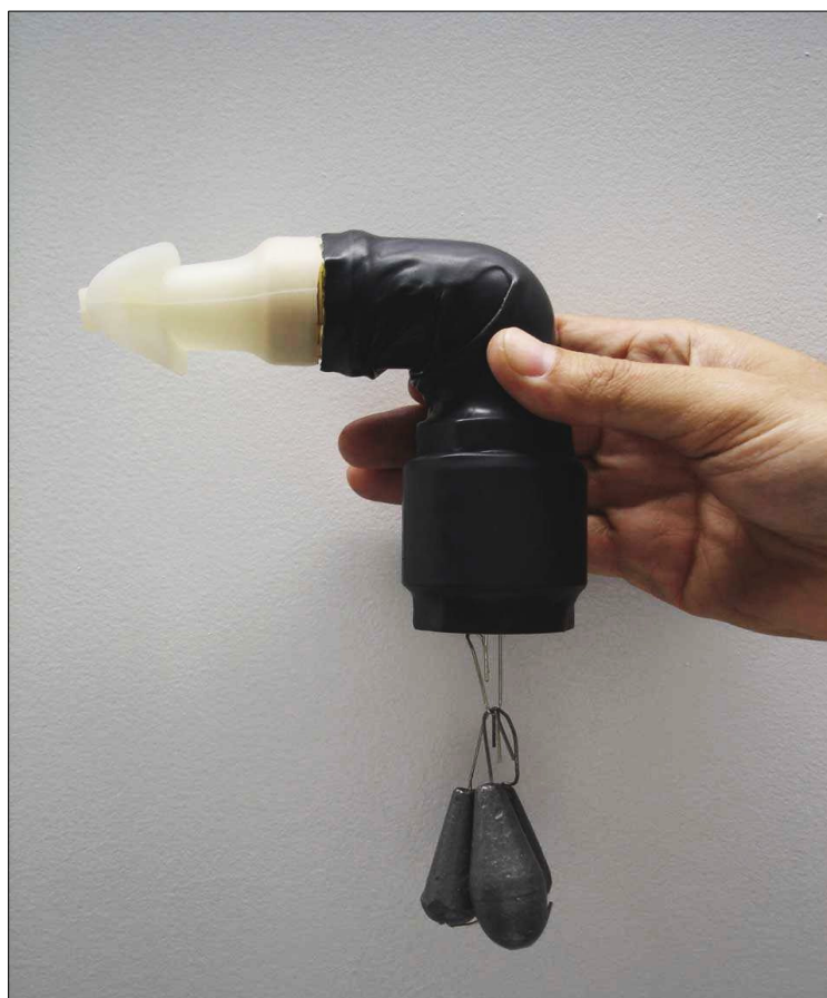
Figura 10: Válvula umbral inspiratoria según el prototipo diseñado en nuestro laboratorio. Se muestra las fases necesarias para la creación de cada válvula. Una modificación a partir de este diseño está con patente en curso (2007, Orozco-Levi M y Gea J).
