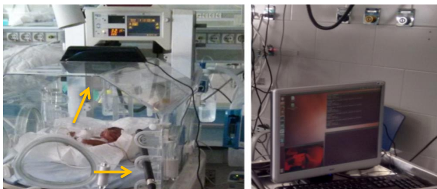
Il·lustració 25. Visió computeritzada dels paràmetres conductuals. A l'esquerra de la imatge, es mostra la càmera Kinect® a sobre la incubadora (moviment) i el micròfon a l'interior de la incubadora per a la captació del plor. A la dreta de la imatge, s'observa l'obtenció dels paràmetres conductuals a través de visió computeritzada.
