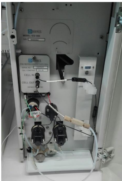
Figura 8. Circuito cerrado de tubos para la limpieza en el cambio de aniones a cationes (o viceversa)
