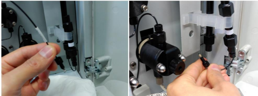
Figura 5 Desconexión del tubo del pre columna y de la columna de separación para purgar
