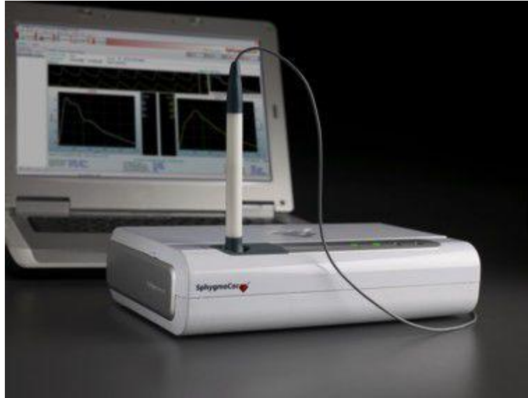
Figura 12. Dispositivo para el estudio de la velocidad de onda de pulso mediante tonometría de pulso Sphygmocor (Atcor EM3, Australia)
