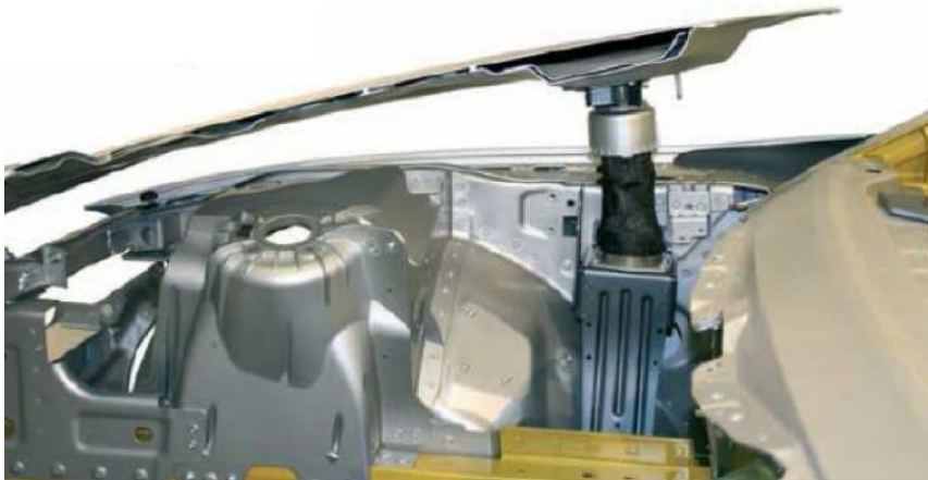
Figura 5.45 Dispositiu pirotècnic d'un capó actiu. Font: "Peña, A. 2006".
