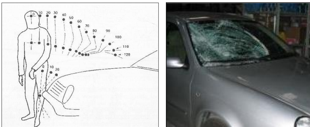
Figura 8.23 Dinàmica del centre gravitacional de masses i danys associats a aquesta mena d'accident. Font: "Servei Català de Trànsit, 2000".
