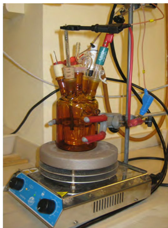
Fig. 2.11. Detalle de las celdas electroquímicas usadas en la electropolimerización de películas de PEDOT en condiciones estáticas (izq.) o dinámicas (der.). Se observan los electrodos y el burbujeador [Producción propia] .
