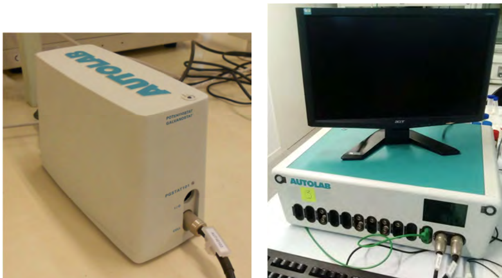
Fig. 2.14. Potencióstato-galvanostatos AUTOLAB utilizados en los estudios experimentales: (izq.) PGSTAT101 y (der.) PGSTAT302N [Producción propia] .
