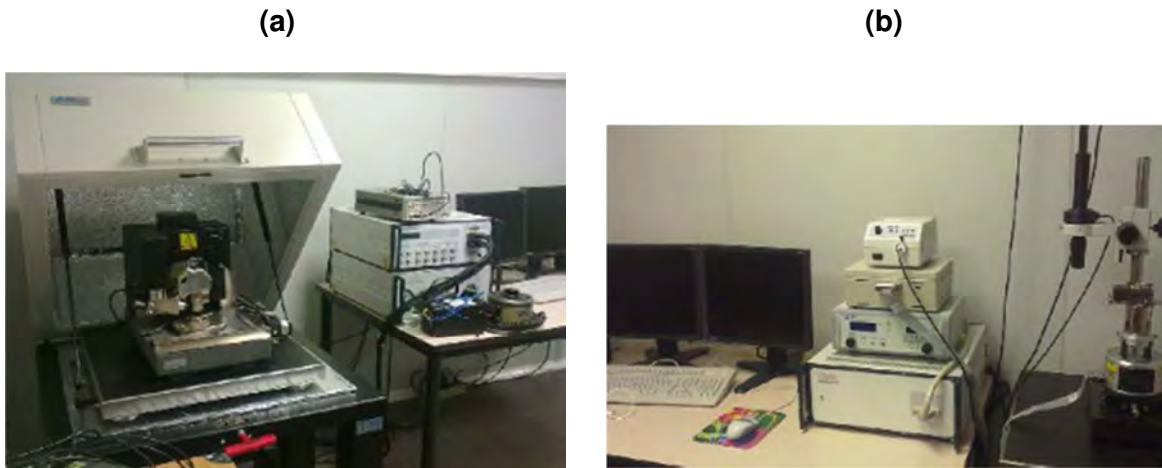
Fig. 2.19. Fotografías de los microscopios para la determinación AFM marca VEECO utilizados en las caracterizaciones AFM de la presente tesis: (a) Dimension 3100 Nanoman y (b) Multimode [16] .
