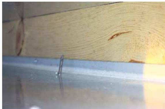
Ilustración 21: Perforación de la lámina metálica interior de la CV para introducir sensores de temperatura
