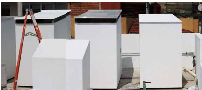
Ilustración 31: Vista de la cubierta ventilada blanca (CVB), la cubierta ventilada sin acabado exterior (CV) y de la cubierta simple blanca (CSB)
