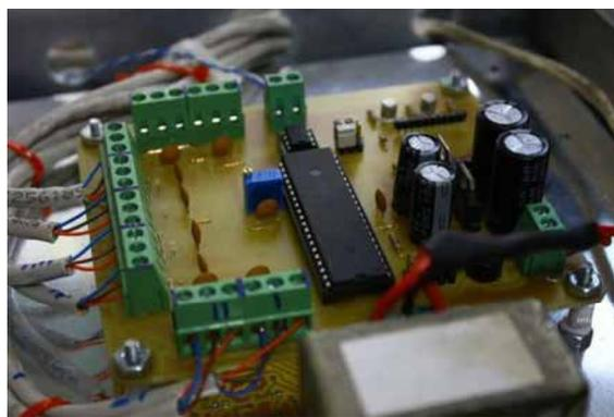
Ilustración 14: Vista de los circuitos del registrador de datos
