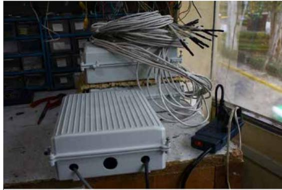
Ilustración 11; Vista Exterior de los registradores de datos antes de instalarlos en los módulos.
