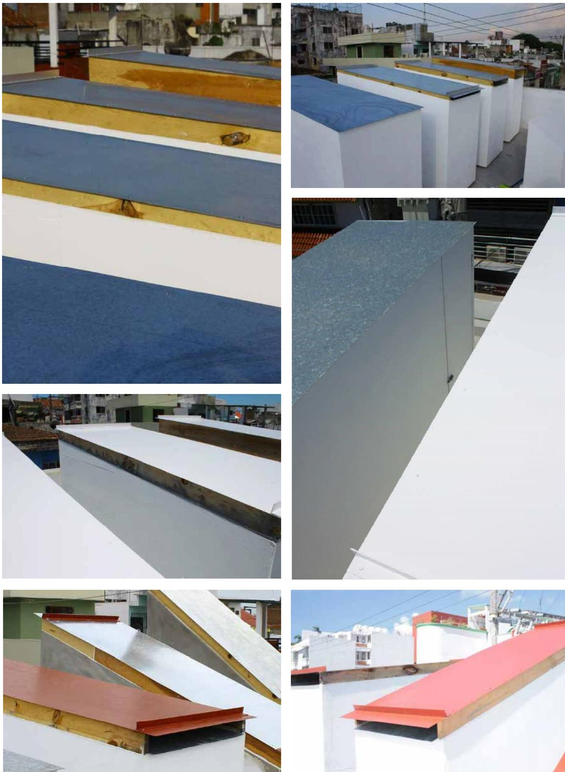
Ilustración 30: En estas fotografías se observa el cambio en el acabado superficial de las CV para los tres primeros grupos de mediciones: Láminas naturales, láminas blancas y láminas rojas
