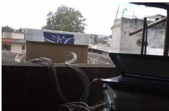
Ilustración 17: Pruebas realizadas a los sensores antes de su colocación en los módulos. Se adhirieron a una lámina metálica dentro de una caja colocada a la intemperie y se conectaron a una computadora que desplegaba los registros de temperatura minuto a minuto.
