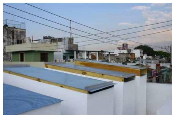
Ilustración 7: Vista final del primer grupo de módulos del experimento. Cubiertas Ventiladas de 5, 10 y 20 cm. Sin acabado de la lámina metálica
