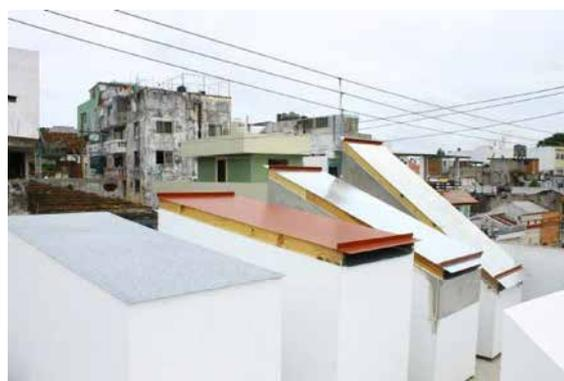
Ilustración 27: Vista de los módulos que conformaron el 3° grupo de mediciones. Las CV de 6°, 21° y 36° de inclinación junto al modelo de CS.
