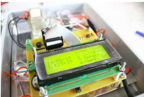
Ilustración 13: Pantalla LCD del registrador de datos que despliega el menú de programación
