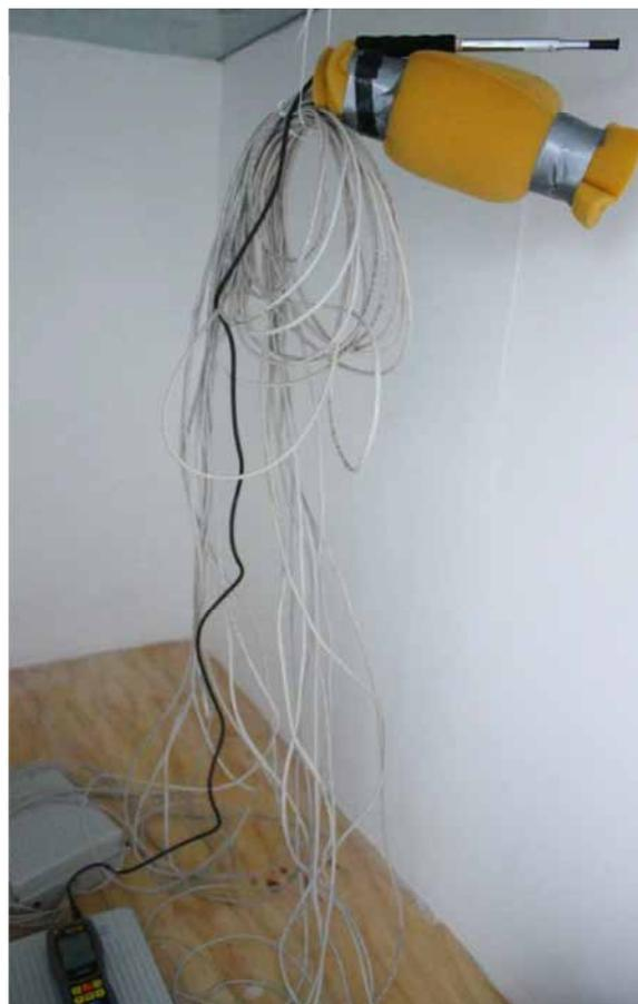
Ilustración 24: Colocación de termómetro adicional a los sensores para verificar calibración.
