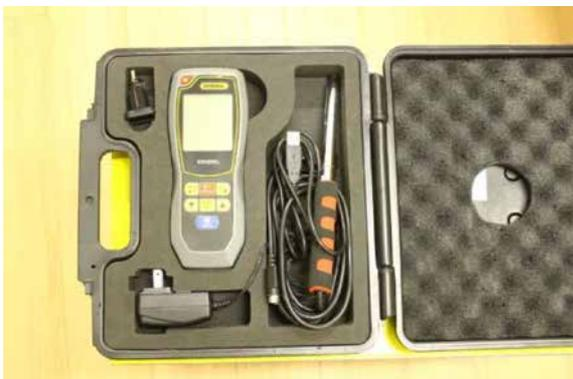
Ilustración 20: Anemómetro de hilo caliente utilizado para medir velocidad del aire dentro de las CV
